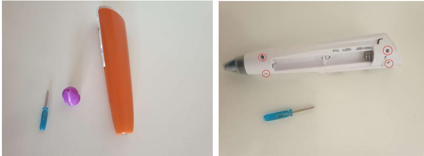
Die vier markierten (ABB) kleinen Kreuzschlitzschrauben entfernen.
